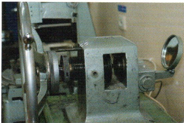
Rys. 2.4 Maszyna do badania tężności blachy metodą Erichsena
