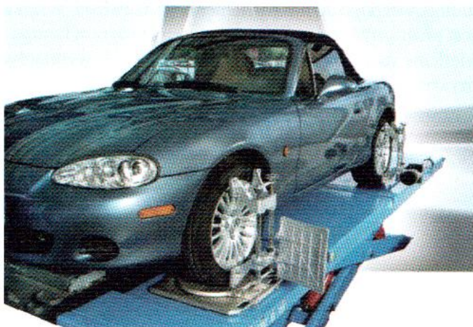
Rys. 3.23 Pomiar ustawienia kół samochodu za pomocą wiązki laserowej [14]
