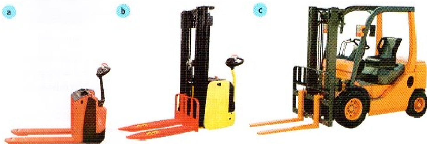
Ryc. 31.2. Rodzaje wózków zmechanizowanych: (a) elektryczny paletowy, (b) stertownik, (c) widłowy czołowy
