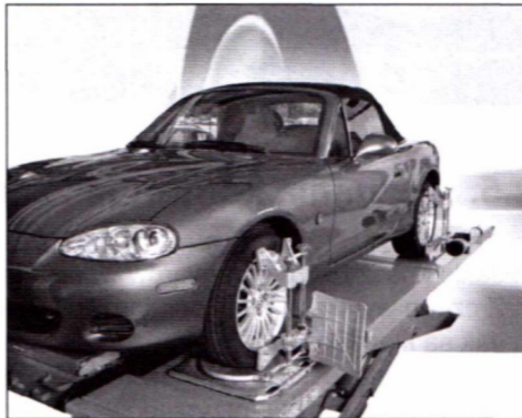
Rys. 2.23. Pomiar ustawienia kół samochodu za pomocą wiązki laserowej [14]
