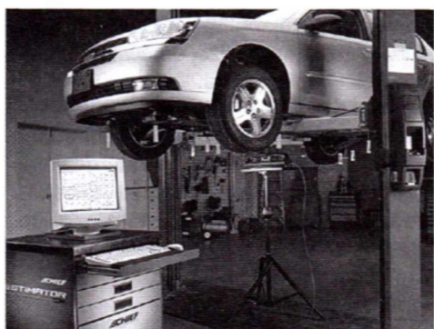
Rys. 2.24. Wykorzystanie wiązek laserowych do pomiarów płyty podłogowej [14]
