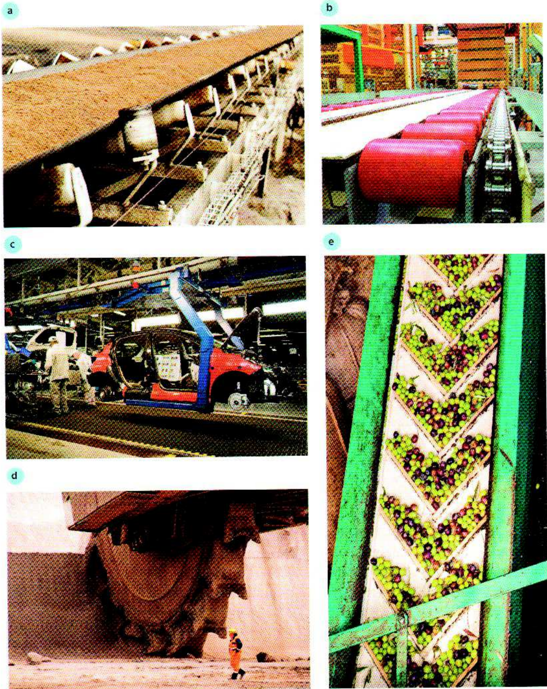
Ryc. 31.8. Rodzaje przenośników: a) taśmowy, b) łańcuchowy, c) podwieszany, d) kubelkowy, e) zabierakowy
