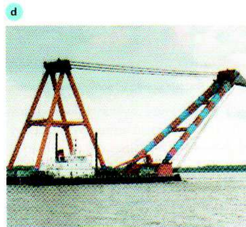
Ryc. 31.5. Rodzaje żurawi w zależności od ich umiejscowienia: (a) bramowy, (b) kolejowy, (c) pokładowy, (d) pływający
