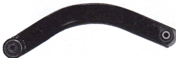
Rys. 3.42. Wahacz z osadzonymi tulejami metalowo-gumowymi
