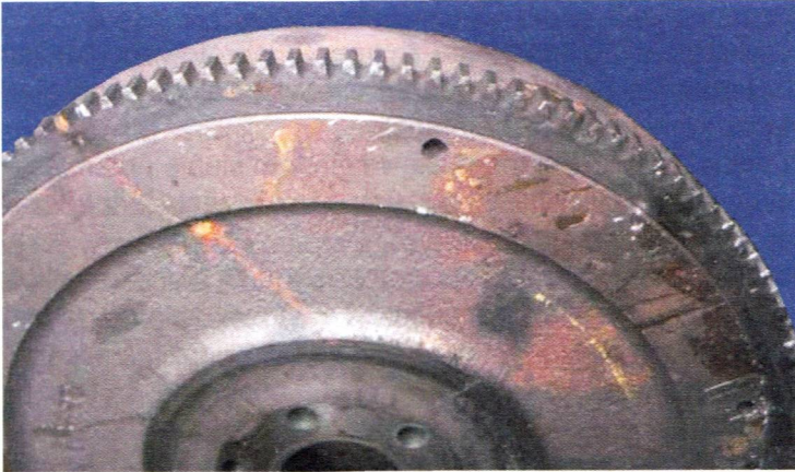
Rys. 3.43. Koło zamachowe z osadzonym skurczowo wieńcem zębatym
