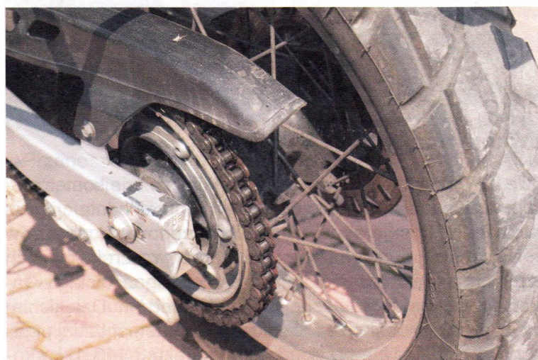
Rys. 3.146. Przeniesienie napędu w motocyklu za pomocą przekładni łańcuchowej
