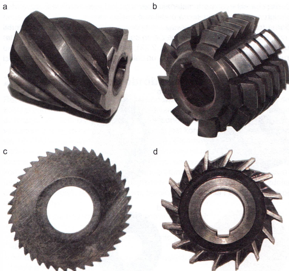
Rys. 2.22. Rodzaje frezów a – walcowy, b – ślimakowy, c – tarczowy piłkowy, d – tarczowy
