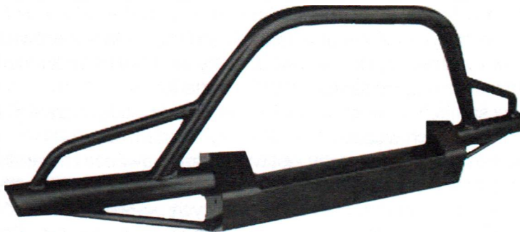
Rys. 3.36. Spawana konstrukcja wspornika zderzaka samochodu BMW
