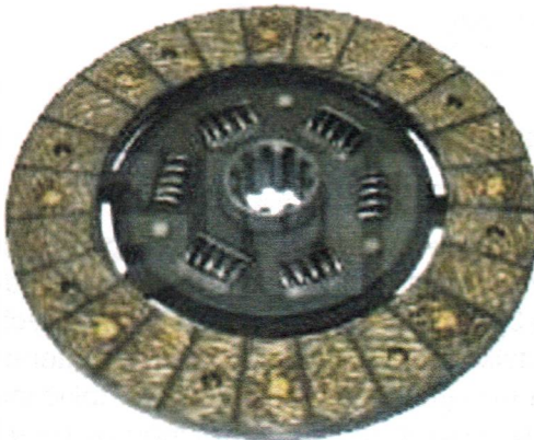
Rys. 3.35. Tarcza sprzęgła samochodu Żuk z przynitowanymi okładzinami ciernymi
