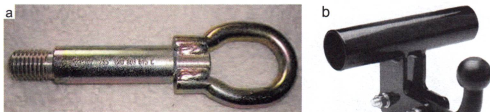
Rys. 3.88. Przykłady połączeń gwintowych w pojazdach samochodowych
