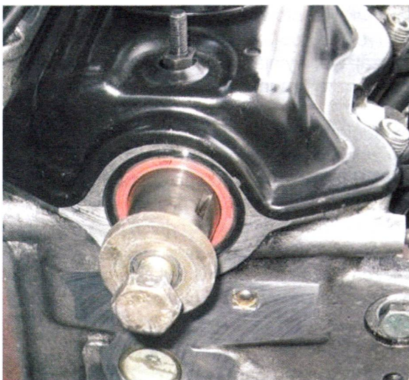
Rys. 3.83. Gniazdo wpustu czółenkowego na końcu wału rozrządu
