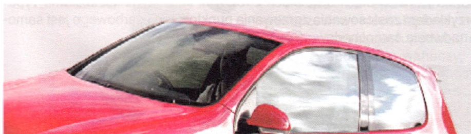
Rys. 3.40. Szyby samochodowe przyklejone do nadwozia
