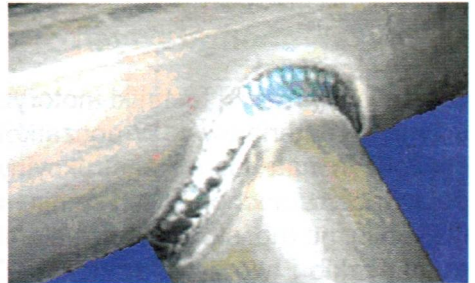
Rys. 3.37. Spawane złącze belki zawieszenia tylnego
