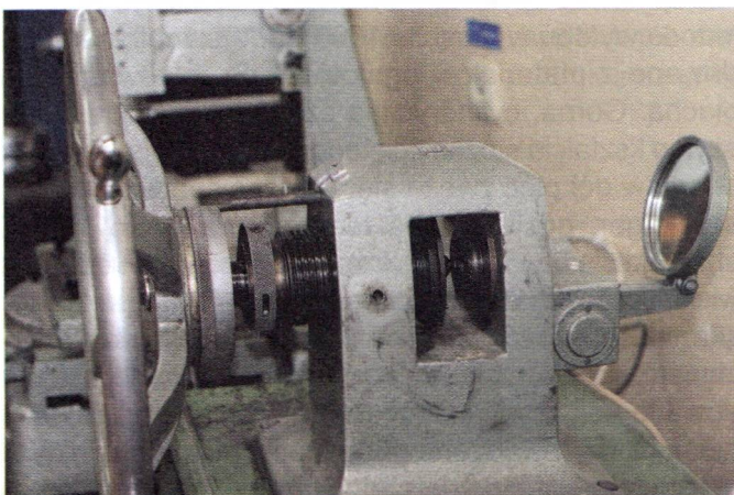
Rys. 1.4. Maszyna do badania tłoczności blachy metodą Erichsen
