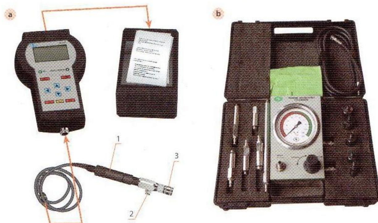
Rys. 9.13. i fot. 9.4. (a) Próbnik ciśnienia z rejestratorem samopiszącym, (b) próbnik ciśnienia z manometrem
