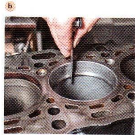
Rys. 9.24. i fot. 9.11. Pomiar luzu zamka pierścienia w cylindrze: (a) szkic, (b) widok
