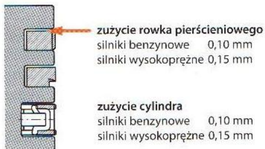
Rys. 9.23. a) Maksymalny luz pierścieni i b) zasada pomiaru
