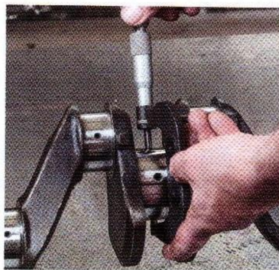
Rys. 9.31. i fot. 9.16. Przykład pomiaru średnic czopów głównych i korbowych wału korbowego śrubą mikrometryczną
