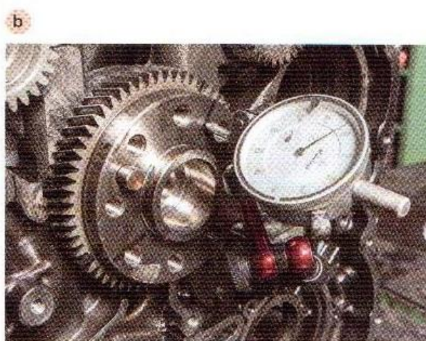
Rys. 9.44. i fot. 9.24. Ocena luzu osiowego wału korbowego za pomocą czujnika zegarowego: (a) schemat, (b) widok
