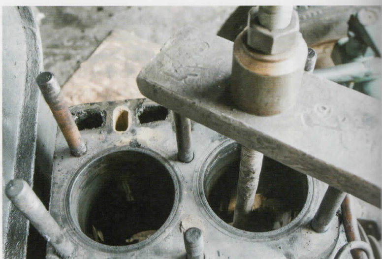
Ryc. 12.20. Demontaż mokrej tulei cylindrowej
