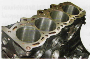
Ryc. 12.2. Blok silnika R4 z zamkniętym płaszczem wodnym
