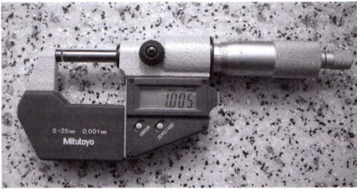
Rys. 2.22. Mikrometr z odczytem cyfrowym typu Mitutoyo 293 521 30
