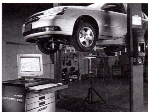
Rys. 2.24. Wykorzystanie wiązek laserowych do pomiarów płyty podłogowej [14]
