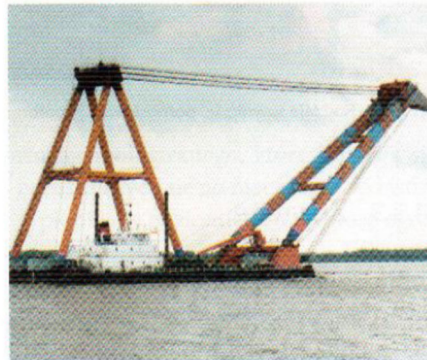
Ryc. 31.5. Rodzaje żurawi w zależności od ich umiejscowienia: a) bramowy, b) kolejowy, c) pokładowy, d) pływający
