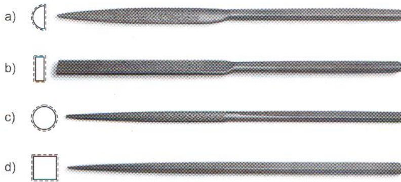
Rys. 5.5. Przykłady tarników: a) półokrągły, b) płaski, c) okrągły, d) czworokątny
