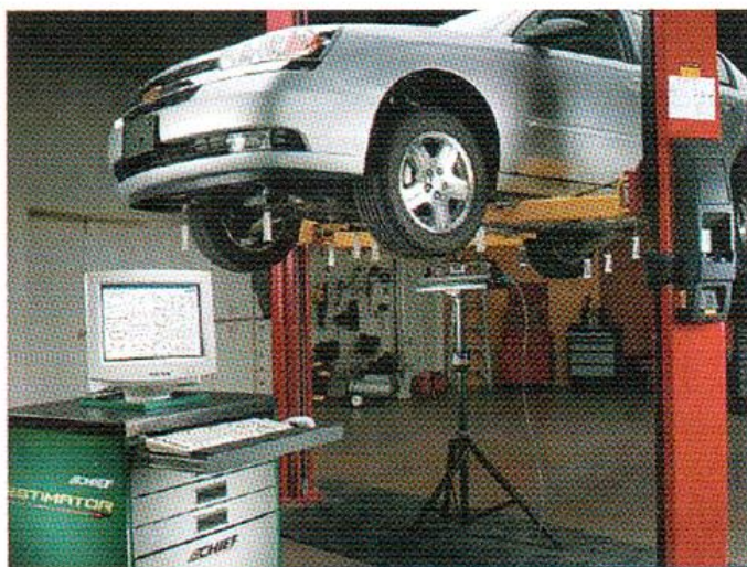
Rys. 3.24 Wykorzystanie wiązek laserowych do pomiarów płyty podłogowej [14]
