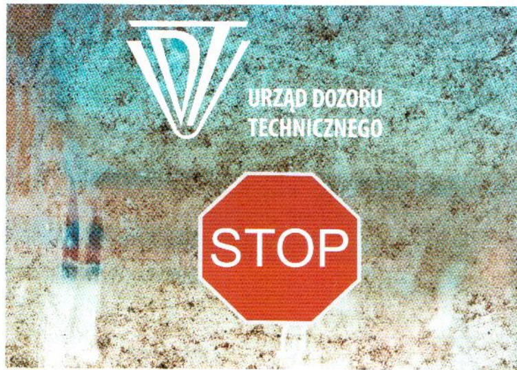
Rys. 5.1. Znak Urzędu Dozoru Technicznego oznaczający wstrzymanie eksploatacji
