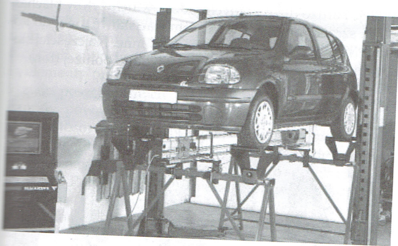
Stanowisko diagnostyczne wyposażone w urządzenie ultradźwiękowe oraz statyw pomiarowy. (Blackhawk)
