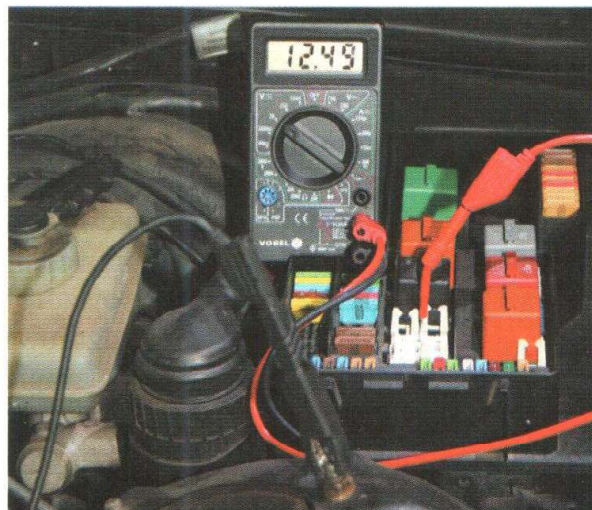
Rys. 2.8. Widok sposobu wykonania pomiaru: a) napięcia zasilania na bezpieczniku, b) napięcia w gnieździe 30 przełącznika
