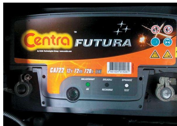
Rys. 4.8. Wskaźnik naładowania bezobsługowego akumulatora pojazdu (tzw. magiczne oczko)
