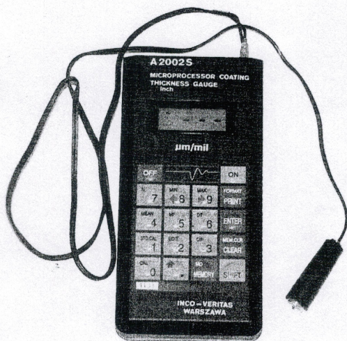
Rys. 28.27. Przyrząd elektroniczny do pomiaru grubości powłok niemagnetycznych na podłożach magnetycznych
