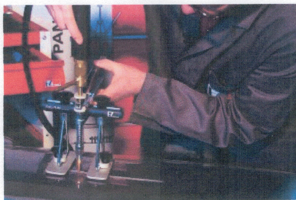
Fot.3. EASY PULLER podczas usuwania rysy na drzwiach. (EZ DENT)
