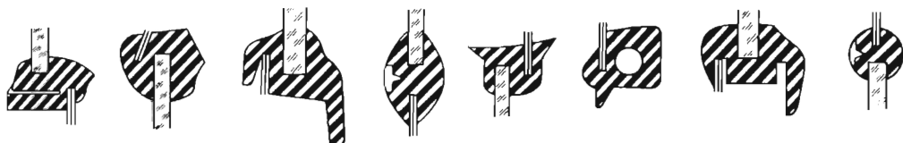
Rys. 17-2. Kształty przekroju uszczelki szyb okien nieotwieranych
