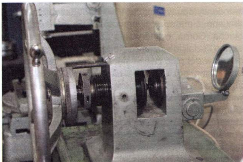
Rys. 1.4. Maszyna do badania tłoczności blachy metodą Erichsena
