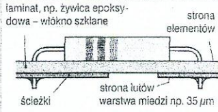
Rys. 2. Przekrój płytki obwodu drukowanego
