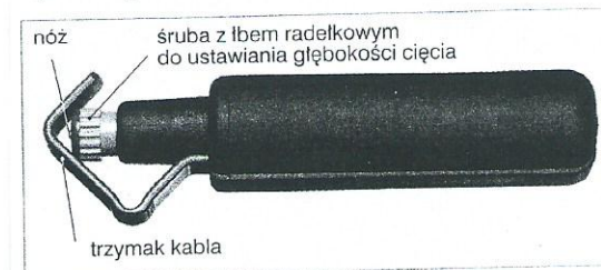
Rys. 3. Nóż do zdejmowania płaszczka zewnętrznego
