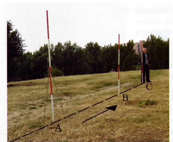
Rys. 17. Tyczenie prostej w terenie metodą „na siebie” [1, s. 160]
