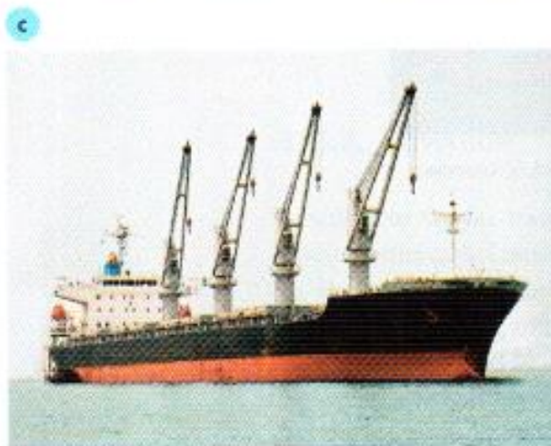
Ryc. 31.5. Rodzaje żurawi w zależności od ich umiejscowienia: a) bramowy, b) kolejowy, c) pokładowy, d) pływający
