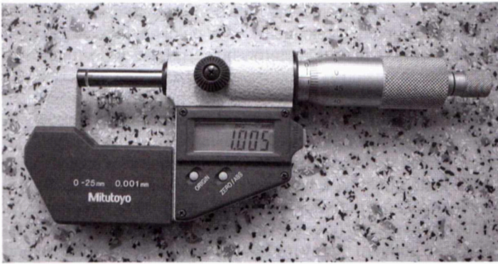
Rys. 2.22. Mikrometr z odczytem cyfrowym typu Mitutoyo 293 521 30
