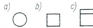
Rys. 18.15. Symbole graficzne przyrządów pomiarowych: a) miernik wskazówkowy, b) miernik rejestrujący, c) licznik
