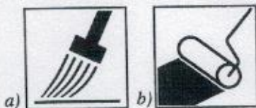
Rys. 1-1. Nakładanie powłok, a) pędzlem, b) wałkiem
