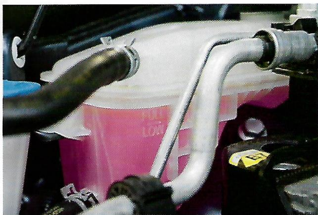
Ryc. 13.9. Zbiornik wyrównawczy z zaznaczonym poziomem cieczy chłodzącej
