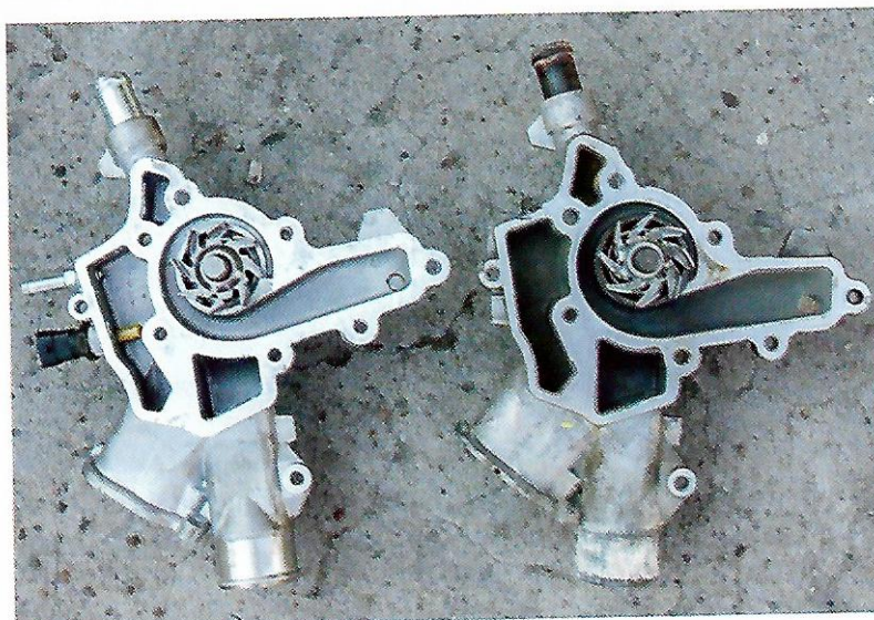
Ryc. 13.11. Pompa ciecchy chłodzącej: nowa (po lewej stronie) i używana (po prawej stronie)
