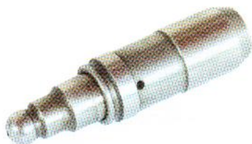
Ryc. 11.38. Hydrauliczny regulator luzu zaworowego dźwigienki zaworowej
