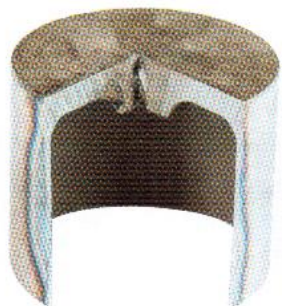
Ryc. 11.39. Mechaniczny popychacz tzw. szklankowy
