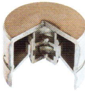
Ryc. 11.40. Popychacz szklankowy z hydrauliczną regulacją luzu zaworowego
