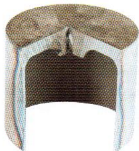
Ryc. 11.39. Mechaniczny popychacz tzw. szklankowy
