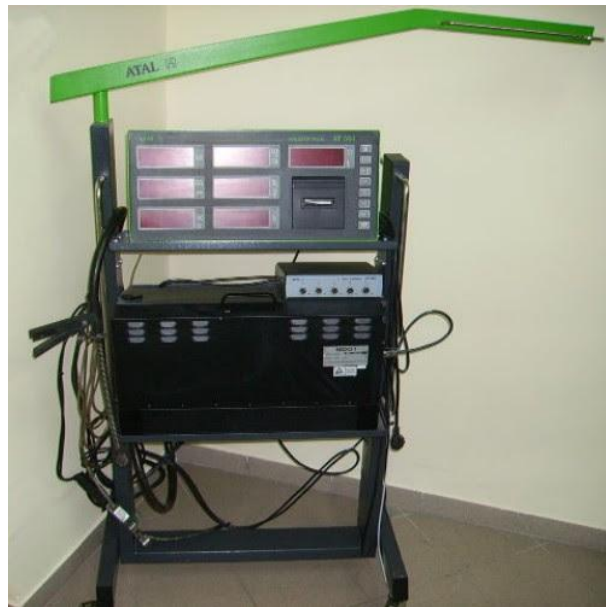
Dymomierz absorcyjny o częściowym przepływie spalin [Oliver D-60].
