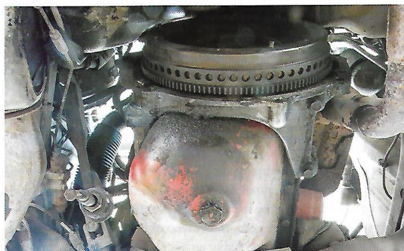
Ryc. 4.27. Widok na koło zamachowe po zdemontowaniu skrzyni biegów
