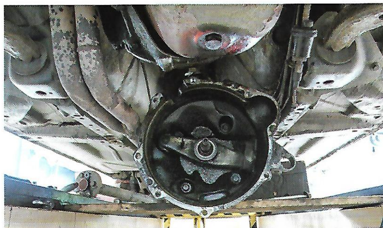
Ryc. 4.26. Zdemontowana skrzynia biegów
