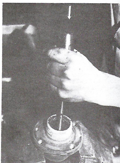
Rys. 8.12. WYBIJANIE BIEŻNI ŁOŻYSKA WEWNĘTRZNEGO
