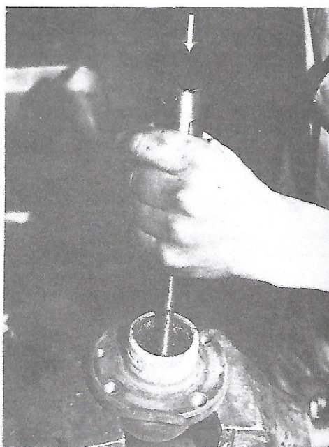
Rys. 8.12. WYBIJANIE BIEŻNI ŁOŻYSKA WEWNĘTRZNEGO
