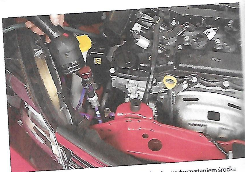
Rys. 11.36. i fot. 11.12. (a) Sposób wykonania próby szczelności układu chłodzenia, (b) urządzenie do wytworzenia ciśnienia
