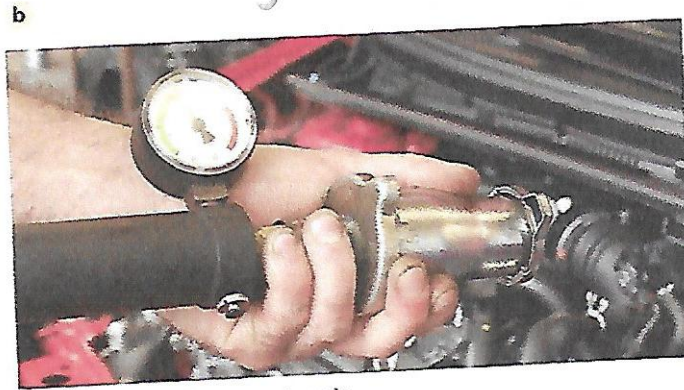
34. i fot. 11.10. Sprawdzenie zaworu ciśnieniowego: (a) ręczne otwarcie, (b) z użyciem przyrządu
