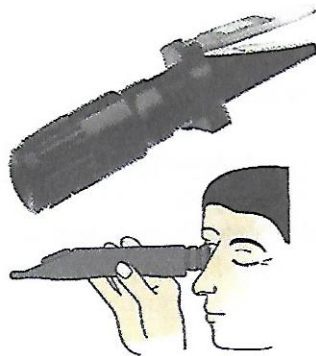
Rys. 11.23. i fot. 11.3. Pomiar glikometrem gęstości cieczy chłodzącej: (a) schemat, (b) widok
