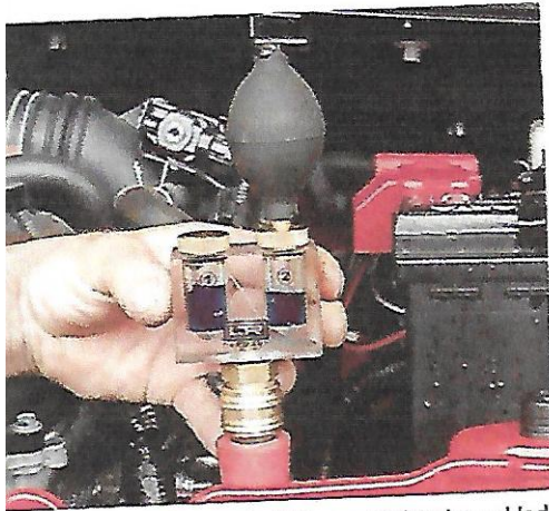
Fot. 11.15. Wyniki testu CO 2 ; (a) barwa niebieska – układ nieszczelny, (b) barwa zielona – układ szczelny
