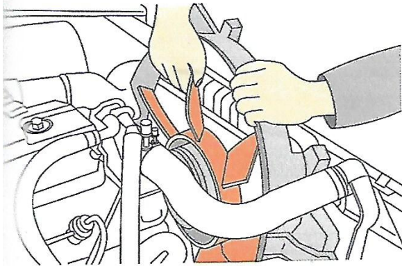
Rys. 11.25. Sprawdzenie bicia łopatek wentylatora
