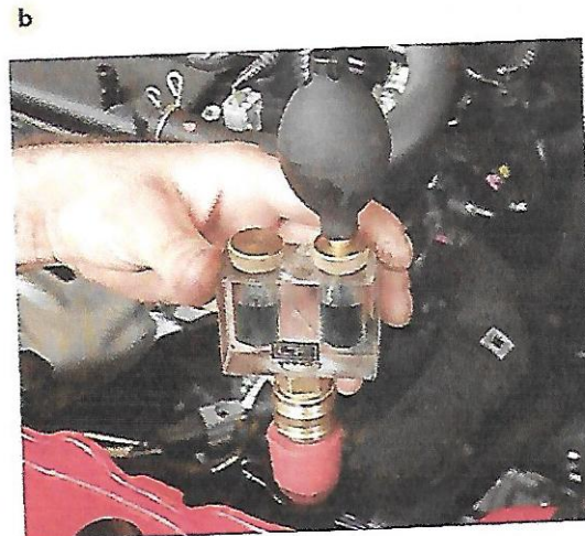
Fot. 11.15. Wyniki testu CO 2 ; (a) barwa niebieska – układ nieszczelny, (b) barwa zielona – układ szczelny
