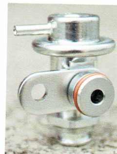
Ryc. 16.14. Przykładowy regulator ciśnienia paliwa
