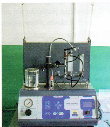
Ryc. 16.12. Urządzenie do testowania i czyszczenia wtryskiwaczy
