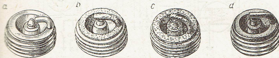
Rys. 184. Ocena prawidłowości pracy świecy zapłonowej: a — prawidłowo pracująca świeca — elektrody mają lekki nalot barwy ciemnoszarej do białej, b — świeca przegrzana — koniec izolatora zapieczony stalowoniebieski do brązowego, elektrody wypalone, c — świeca zaolejona — elektrody i izolator pokryte wilgotną czarną warstwą oleju, d — świeca za zimna — koniec izolatora i elektrody pokryte suchym czarnym nalotem sadzy
