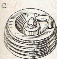
Rys. 184. Ocena prawidłowości pracy świecy — elektrody mierzalne — przegrzana — koniec izolatora wypalony, c — świeca z warstwą oleju, d — świeca z czarnym nalotem sadzy
