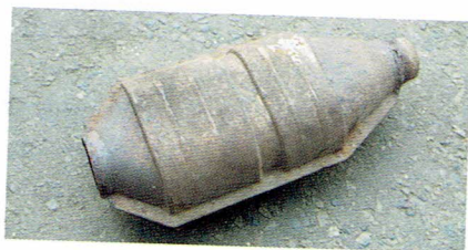
Ryc. 15.20. Zdemontowany zużyty katalizator
