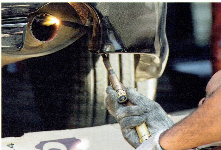
Ryc. 15.15. Demontaż tłumika przez wycięcie palnikiem
