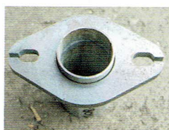
Ryc. 15.19. Flansa montażowa układu wydechowego
