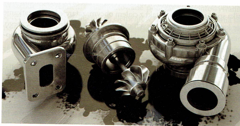
Ryc. 15.5. Części składowe turbosprężarki po rozbiórce
