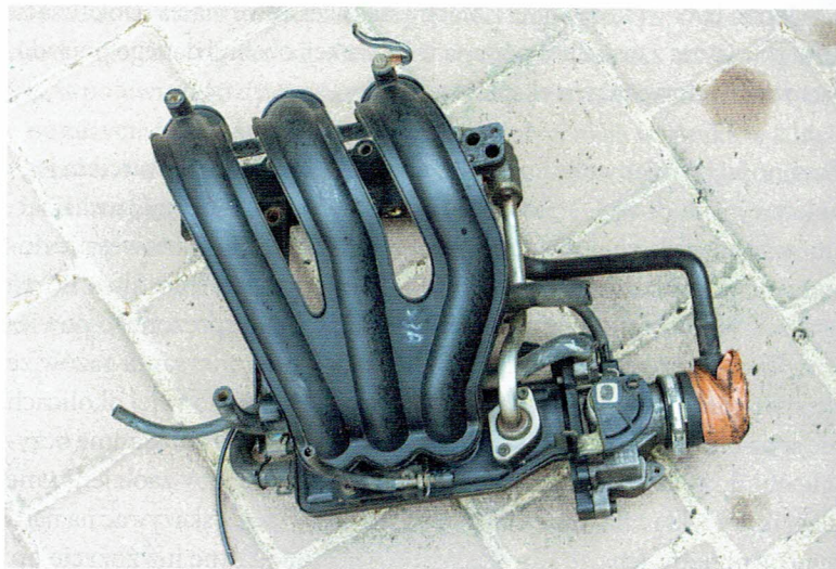
Ryc. 15.3. Kolektor dolotowy wykonany z tworzywa sztucznego
